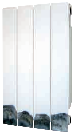
Degradación de un radiador instalado con cañerías plásticas sin aluminio.
