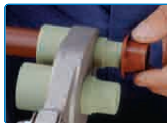
Fusione el buje al tubo.
