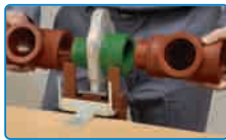
Transcurrido un minuto, fusione el conjunto, accesorio-entre-fusión, a un nuevo accesorio.
